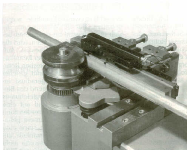
Bild 3: Das Rohr wird mit einer Spannbacke fixiert, die Gegenhalterschiene an den freien Rohrschenkel herangefahren
